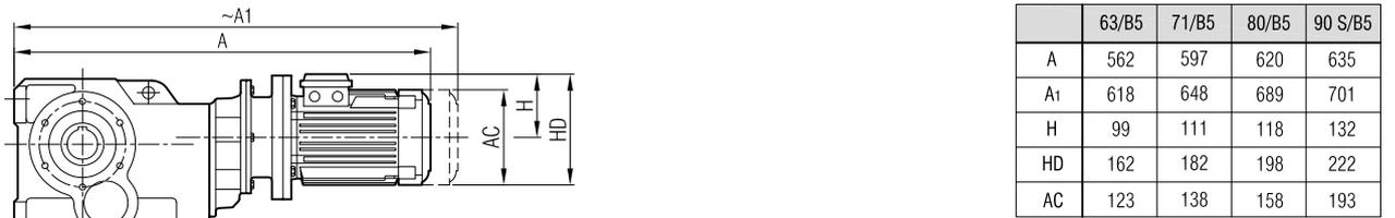
**"A<sub>1</sub>" Ölçüsü Frenli Motorlar içindir.**
