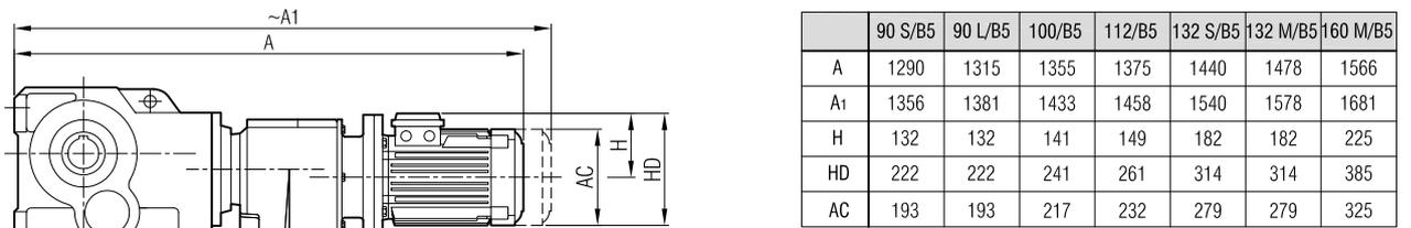
**"A<sub>1</sub>" Ölçüsü Frenli Motorlar içindir.**
