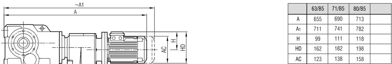
**"A<sub>1</sub>" Ölçüsü Frenli Motorlar içindir.**
