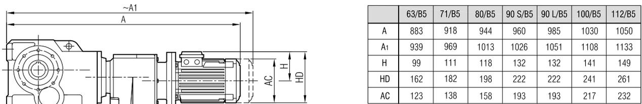
**"A<sub>1</sub>" Ölçüsü Frenli Motorlar içindir.**
