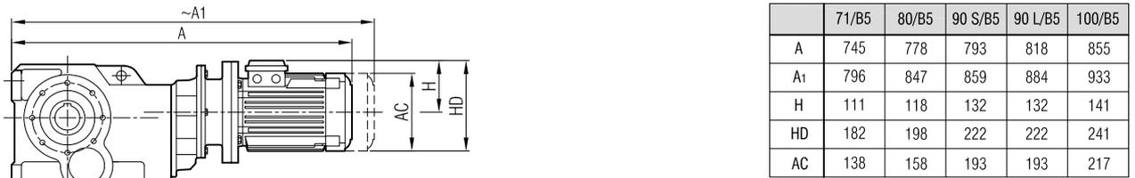
**"A<sub>1</sub>" Ölçüsü Frenli Motorlar içindir.**
