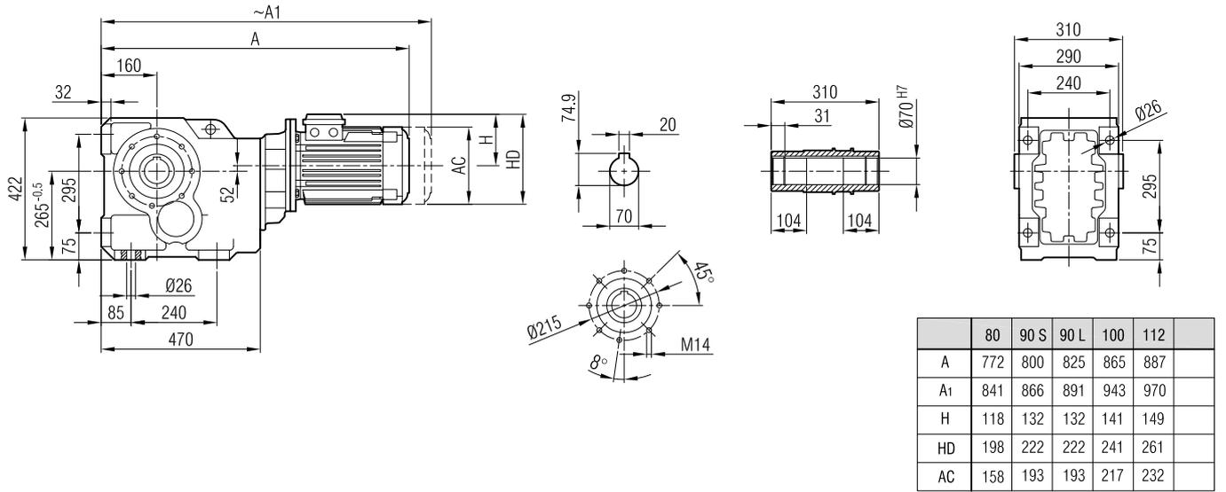
**"A<sub>1</sub>" Ölçüsü Frenli Motorlar içindir.**
