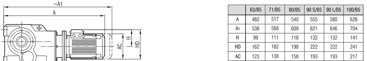
**"A<sub>1</sub>" Ölçüsü Frenli Motorlar içindir.**
