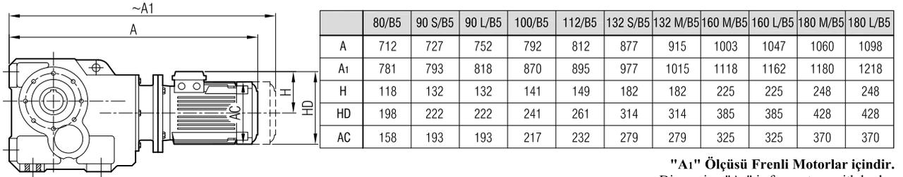
"A<sub>1</sub>" Ölçüsü Frenli Motorlar içindir.
