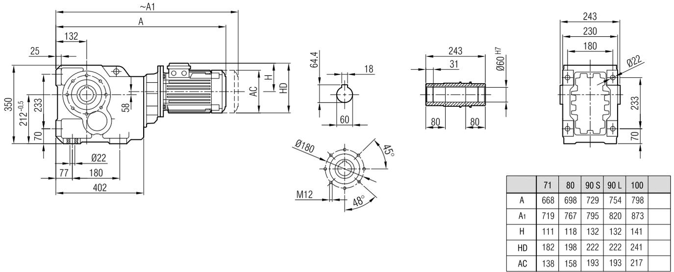
**"A<sub>1</sub>" Ölçüsü Frenli Motorlar içindir.**
