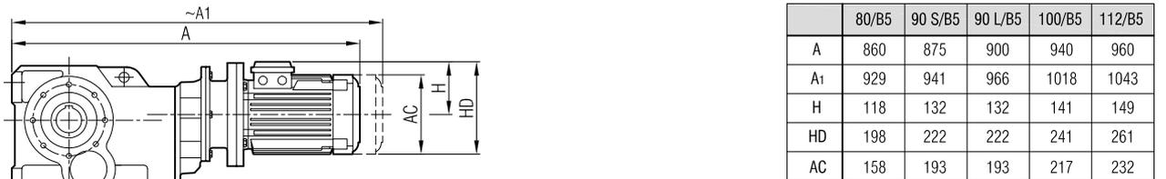
**"A<sub>1</sub>" Ölçüsü Frenli Motorlar içindir.**
