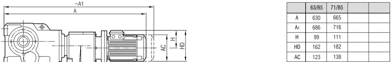
"A<sub>1</sub>" Ölçüsü Frenli Motorlar içindir.
