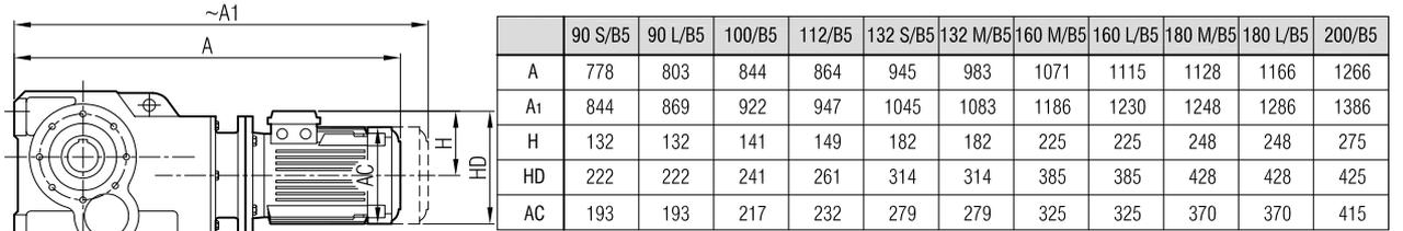
"A<sub>1</sub>" Ölçüsü Frenli Motorlar içindir.
