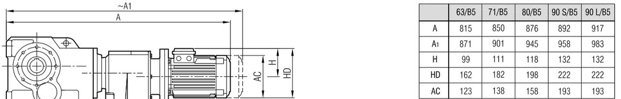
**"A<sub>1</sub>" Ölçüsü Frenli Motorlar içindir.**
