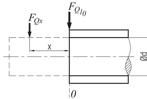
Radyal yük, kovanın 0 noktasında değil ise  $F_{Qx} = F_{Ql_0} \cdot \frac{k}{c+x}$  formülü ile hesaplanır.
